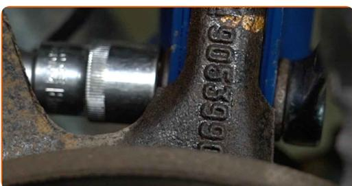
**43** Stram nedre fester som kobler fjærbein til styrespindel. Bruk en kombinasjonsnøkkel #18. Bruk en pipenøkkelinnsats #18. Bruk en momentnøkkel. Stram den til 90 Nm dreiemoment. +45°+15°
