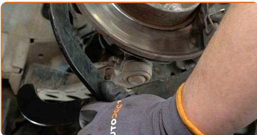
**14** Skru løs festene som kobler fjærbeinet til styrespindelen. Bruk en kombinasjonsnøkkel #18. Bruk en pipenøkkelinnsats #18. Bruk en skrallenøkkel.
