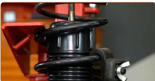
**32** Installer den øvre demperen og monteringslager.
