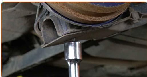
**14** Rengjør festene til støtdemperen. Bruk en stålbørste. Bruk WD-40 spray.
