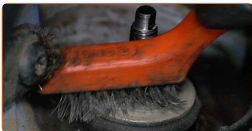
**7** Løsne det øvre festelementet til støtdemperen. Bruk en kombinasjonsnøkkel #14. Bruk et støtdemperverktøy DDN<sup>o</sup>5,2.
