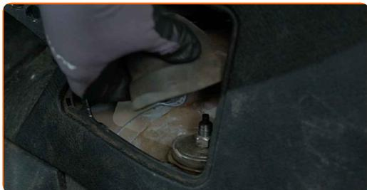
**6** Rengjør festene til støtdemperen. Bruk en stålbørste. Bruk WD-40 spray.
