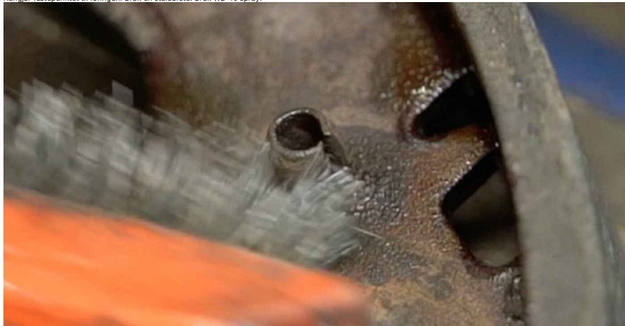
30 Fjern foringen. Bruk vannpumpetenger.
