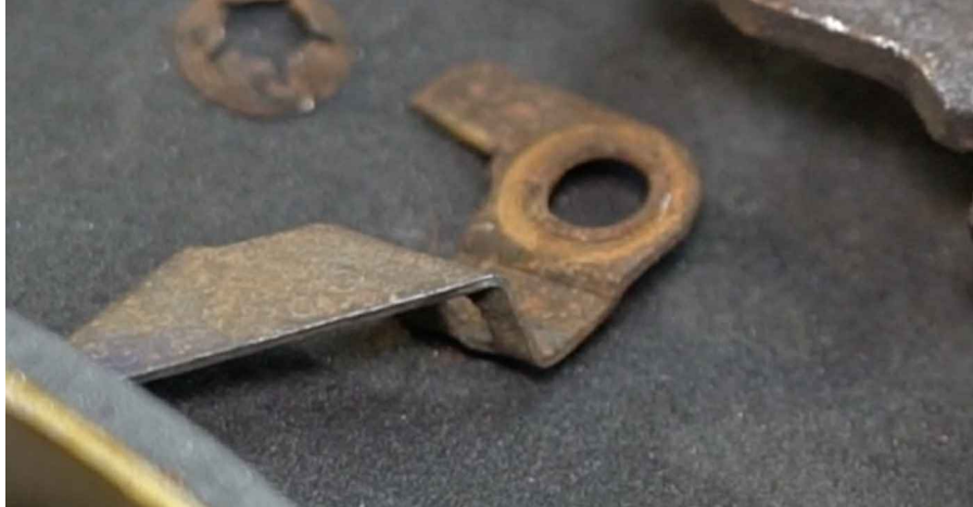
29 Rengjør festepunktet til foringen. Bruk en stålborste. Bruk WD-40 spray.
