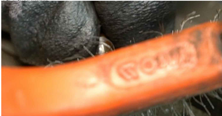
32 Monter foringen på en ny bremsesko. Bruk vannpumpetenger.
