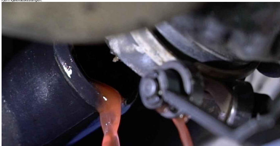
9 Tapp kjølevæsken fra motoren.
