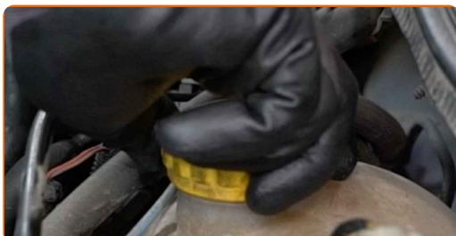
**38** Kjør motoren i noen minutter. Dette må gjøres for å fjerne gjenværende luft fra kjølesystemet og sjekke at komponentene fungerer som de skal.
