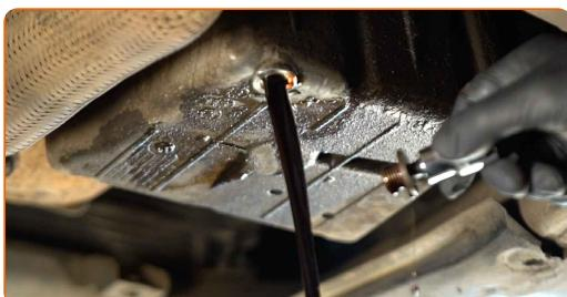
Utskifting: motorolje og oljefilter – OPEL Meriva B (S10). Tips fra AUTODOCs eksperter:
