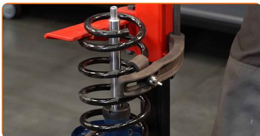
**35** Installer monteringsmansjett og klosser i støtdemperen.
