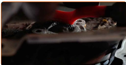
**7** Fjern holderen til det øvre festeelementet til fjærbeinfestet. Bruk et demonteringsverktøy for klemmer.
