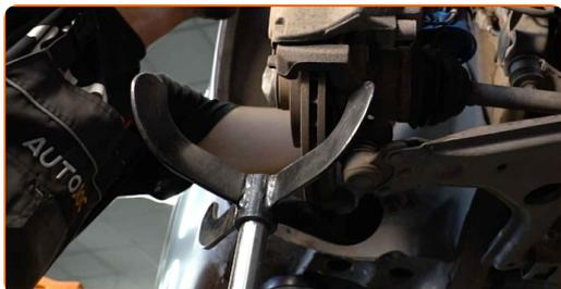
**45** Monter holderen til det øvre festeelementet til fjærbeinfestet. Bruk vannpumpetenger.
