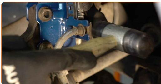
**48** Stram nedre fester som kobler fjærbein til styrespindel. Bruk en kombinasjonsnøkkel #18. Bruk en pipenøkkelinnsats #18. Bruk en momentnøkkel. Stram den til 105 Nm dreiemoment.
