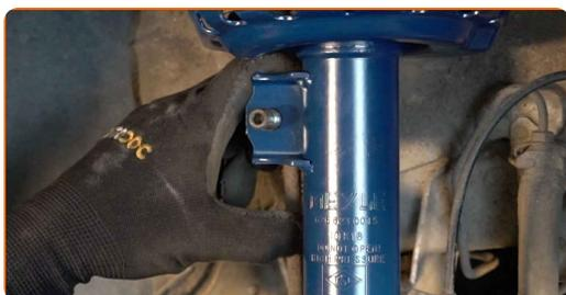
**50** Stram festene som kobler stabilisator-ledd til fjærbein. Bruk en pipenøkkelinnsats #19. Bruk en kombinasjonsnøkkel #19. Bruk en momentnøkkel. Stram den til 55 Nm dreiemoment.
