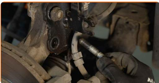
**23** Koble styrespindelen fra fjærbeinet. Bruk et brekkjern.
