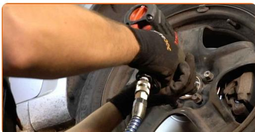
**57** Senk bilen og stram hjulboltene, arbeid på kryss. Bruk en momentnøkkel. Stram den til 110 Nm dreiemoment.
