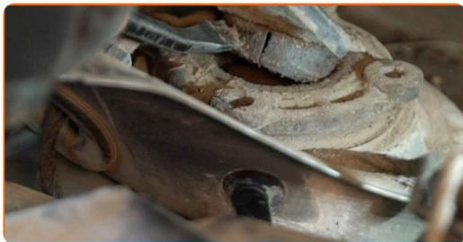
**6** Rengjør festene på fjærbeinets øvre sete. Bruk en stålbørste. Bruk WD-40 spray.
