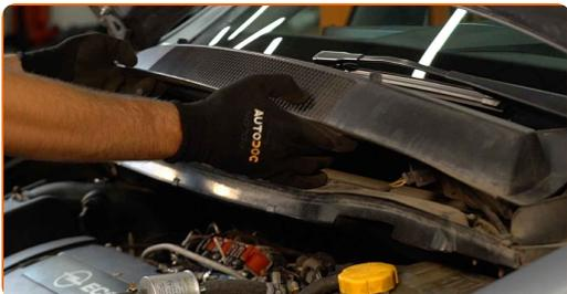
**5** Bytt hetten til monteringen for fjærbeinet. Bruk en flat skrutrekker.
