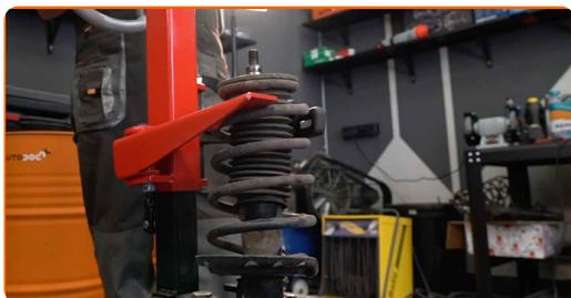
**31** Ta av støtdemper-støvhetten og støtstopperen.
