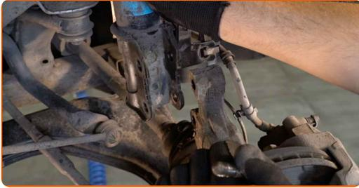
**24** Fjern holderen til det øvre festeelementet til fjærbeinfestet.
