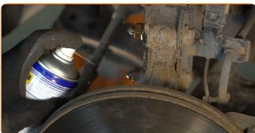
**17** Skru løs nedre feste som kobler fjærbein til styrespindel. Bruk en kombinasjonsnøkkel #18. Bruk en pipenøkkelinnsats #18. Bruk et svingjern.
