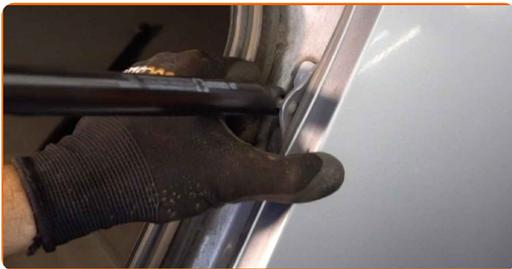
12 Klem på sikringsringen som kobler gassfjæren til bagasjeluken.
