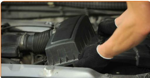
5 Fjern filterelementet fra filterhuset.
