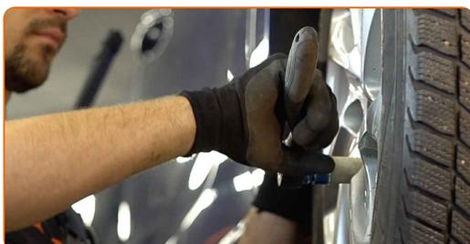
17 Senk bilen og stram hjulboltene, arbeid på kryss. Bruk en momentnøkkel. Stram den til 100 Nm dreiemoment.
