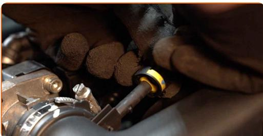
4 Skru løs klemmen som fester luftfilter til strupeventilstuss. Bruk en pipenøkkelinnsats #7.
