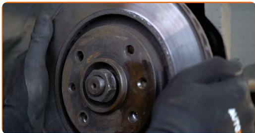
**20** Rengjør festet som forbinder braketten til bremseslangen med fjærbeinet. Bruk en stålbørste. Bruk WD-40 spray.
