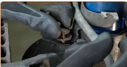
**80** Stram bremseslangen festebrett til sjokk strut. Bruk en pipenøkkelinnsats #13. Bruk en momentnøkkel. Stram den til 12 Nm dreiemoment.
