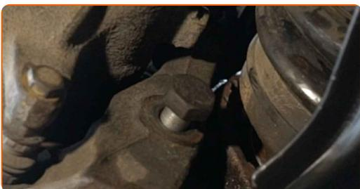
**78** Stram festene til braketten til bremsekaliperen. Bruk en pipenøkkelinnsats #19. Bruk en momentnøkkel. Stram den til 105 Nm dreiemoment.
