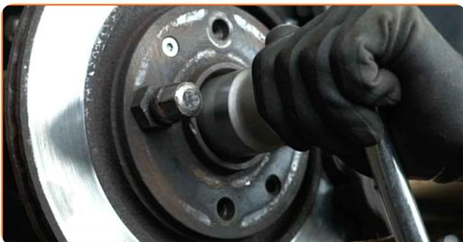
**11** Spre bremseklossene. Bruk et brekkjern.
