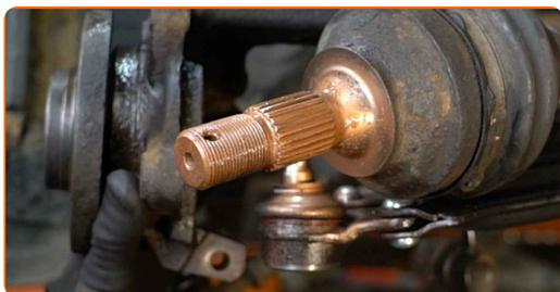
**60** Monter styrespindelen på drivakselen.
