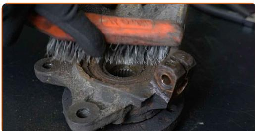
**43** Fjern navet fra styrespindelen. Avtrekkersett for hylser og lager.
