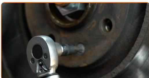
**76** Installer bremsecaliperen sammen med braketten.
