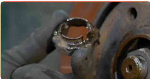
**10** Løsne festet til drivakselen. Bruk en pipenøkkelinnsats #36. Bruk et svingjern.
