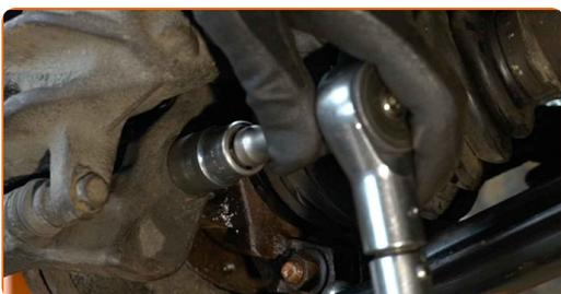
**79** Monter braketten til bremseslangen.
