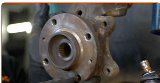
**42** Rengjør låseringen til hjulnavlageret. Bruk en stålborste. Bruk WD-40 spray.
