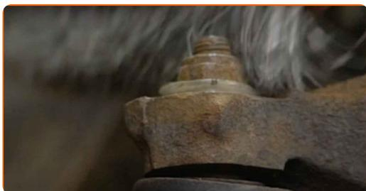
**30** Skru endefestemutteren fast til styrespindelen. Bruk en pipenøkkelinnsats #17. Bruk en skrallenøkkel.
