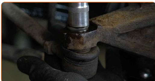
**31** Koble strekkstangenden fra styrespindelen. Bruk en avtrekker for kuleledd.
