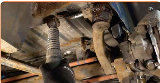
Utskiifting: støtdemper – PEUGEOT 206 Hatchback (2A/C). Tips fra AUTODOCs eksperter:
