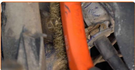
**16** Skru løs festene som kobler stabilisator-ledd til fjærbein. Bruk en pipenøkkelinnsats #16. Bruk Torx T30. Bruk en skrallenøkkel.
