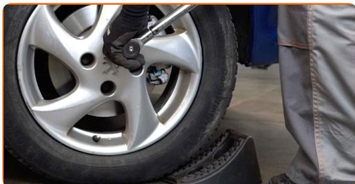
**75** Stram fjærbeinmonteringsens øvre feste. Bruk en pipenøkkelinnsats #13. Bruk en momentnøkkel. Stram den til 25 Nm dreiemoment.
