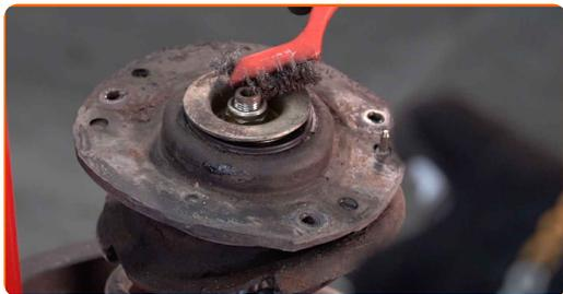
**38** Fjern mutteren på beinets stempelstang. Bruk en pipenøkkelinnsats #21. Bruk HEX nr. H7. Bruk en skrallenøkkel.
