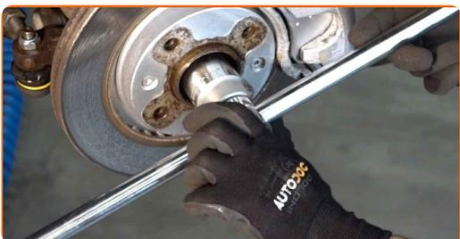
**14** Fjern drivakselen fra styrespindelen. Bruk en spikerdor. Bruk en hammer.
