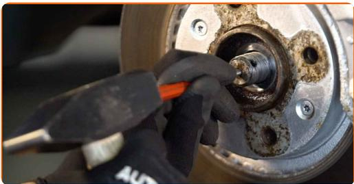
**15** Rengjør festene til stabilisatorleddet. Bruk en stålbørste. Bruk WD-40 spray.
