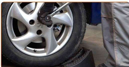
**75** Stram fjærbeinmonteringens øvre feste. Bruk en pipenøkkelinnsats #13. Bruk en momentnøkkel. Stram den til 25 Nm dreiemoment.
