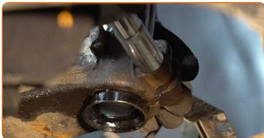
**55** Stram bremseslangen festebrakett til sjokk strut. Bruk en pipenøkkelinnsats #13. Bruk en skrallenøkkel.
