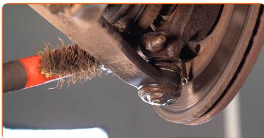
**19** Skru kuleleddfestet til styrespindelen. Bruk en kombinasjonsnøkkel #17. Bruk en pipenøkkelinnsats #17.
