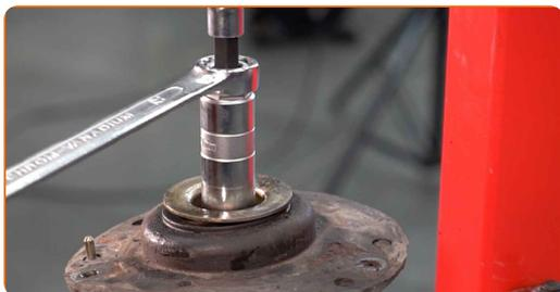
**39** Fjern støtdemperfestet, støvbeskytteren og støtstopperen.
