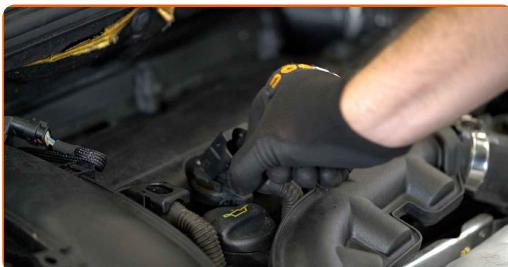
**4** Lirk opp tennspolen. Bruk et brekkjern. Fjern også tennspolen fra hullet til tennpluggen iylinderhodet.
