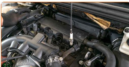
**8** Påfør et tynt lag med et spesielt høytemperaturfett på gjengene til de nye tennpluggene.
