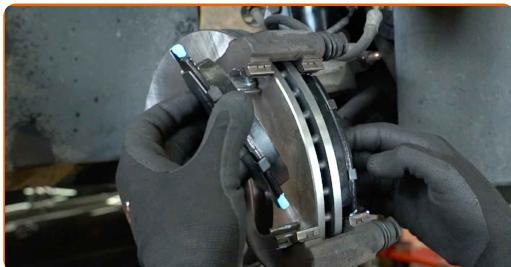
**Utskifting: bremseklosser – PEUGEOT 207 SW Varebil / Stasjonsvogn (WK\_).****Tips fra AUTODOC:**
