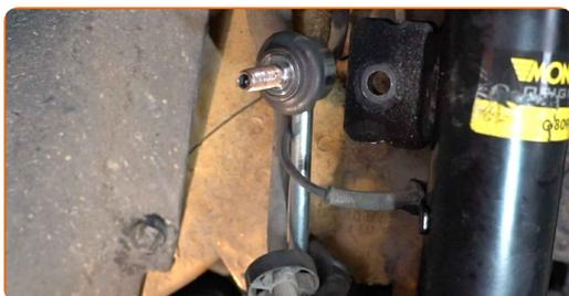
**12** Rengjør festet til braketten som forbinder bremseslangen med fjærbeinet. Bruk en stålbørste. Bruk WD-40 spray.
