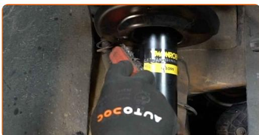
10 Skru løs festene som kobler stabilisator-ledd til fjærbein. Bruk en pipenøkkelinnsats #17. Bruk en skrallenøkkel.
