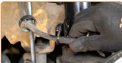
**15** Spre bremseklossene. Bruk et brekkjern.
