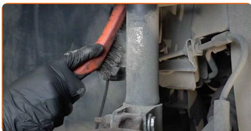
**22** Skru løs festene som kobler stabilisator-ledd til fjærbein. Bruk en kombinasjonsnøkkel #16. Bruk en pipenøkkelinnsats #15. Bruk en skrallenøkkel.
