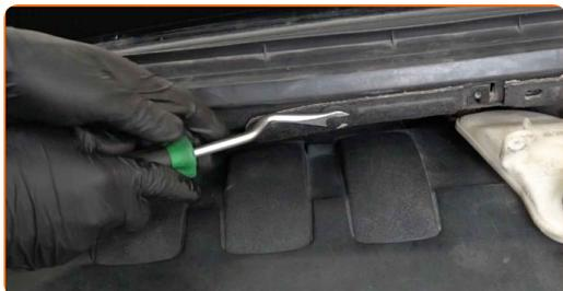
**8** Skru løs festene til torpedoplaten. Bruk en pipenøkkelinnsats #10. Bruk en skrallenøkkel.
