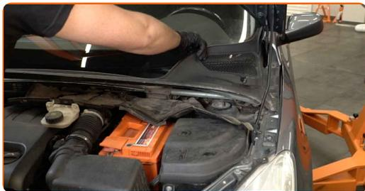
**10** Rengjør festene på fjærbeinets øvre sete. Bruk en stålbørste. Bruk WD-40 spray.
