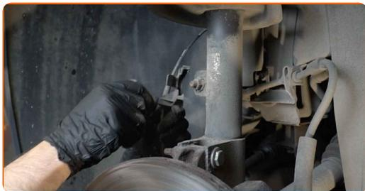
**21** Rengjør festene til stabilisatorleddet. Bruk en stålbørste. Bruk WD-40 spray.
