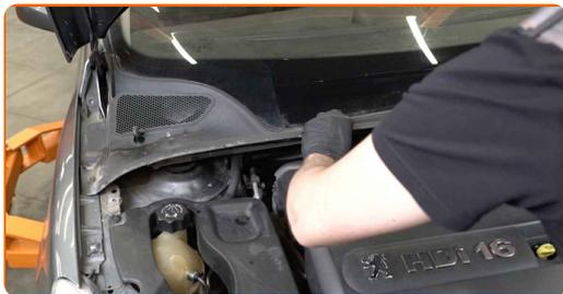
**73** Stram festene til torpedoplaten. Bruk en pipenøkkelinnsats #10. Bruk en skrallenøkkel.
