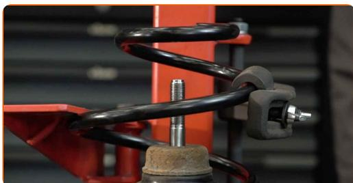
**43** Installer den øvre demperen og monteringslager.
