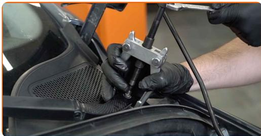
**6** Skru løs festene på bremsevæskebeholderen. Bruk Torx T20. Bruk en skrallenøkkel.
