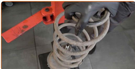
**39** Ta av støtdemper-støvhetten og støtstopperen.
