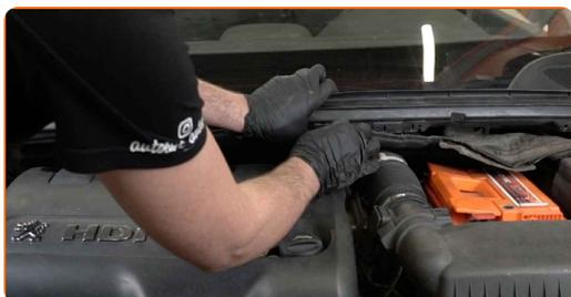
**75** Stram festene på bremsevæskebeholderen. Bruk Torx T20. Bruk en skrallenøkkel.
