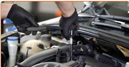
**7** Ta ut tennpluggene. Bruk en uttrekkbar magnet.
