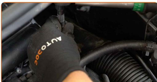
**65** Kjør motoren i noen minutter. Dette må gjøres for å fjerne gjenværende luft fra kjølesystemet og sjekke at komponentene fungerer som de skal.
