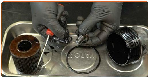
**14** Rengjør dekselet på oljefilterhuset. Bruk en universal rengjøringspray.
