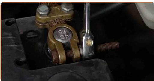
**6** Koble jordingskabelkontakten til batteriet.
