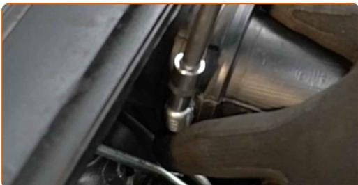
**25** Koble jordingskabelkontakten til batteriet.
