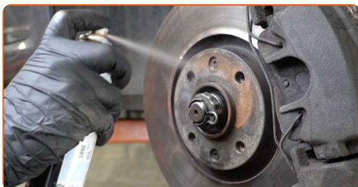
**43** Rengjør overflaten av bremseskiven. Bruk bremsrens.
