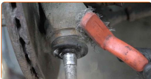
**18** Press løs bærekulen. Bruk en flat metal meisel. Bruk en hammer.
