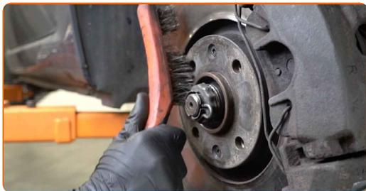
**42** Behandle overflaten hvor bremseskiven kontakter felgen. Bruk kobberfett.
