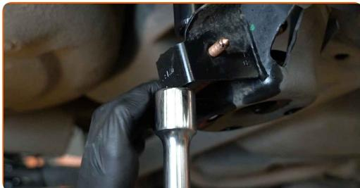
**29** Skru inn det nedre festet til støtdemperen. Bruk en kombinasjonsnøkkel #16. Bruk en pipenøkkelinnsats #16. Bruk en skrallenøkkel.
