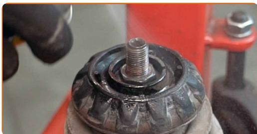
20 Fjern mutteren på beinets stempelstang. Bruk HEX nr. H6. Bruk en pipenøkkelinnsats #21. Bruk en skrallenøkkel.
