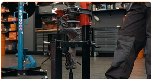
19 Behandle stangen til fjærbeinet. Bruk en stålbørste. Bruk WD-40 spray.
