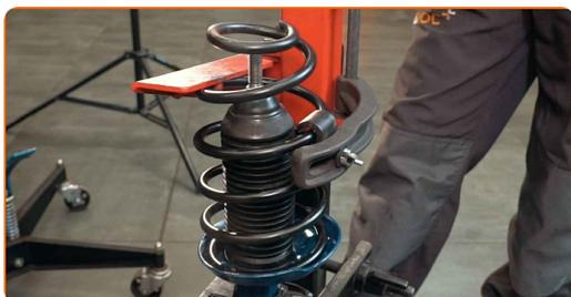
30 Installer den øvre demperen og monteringslager.
