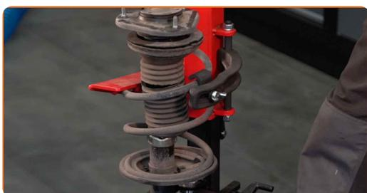
**30** Bytt hetten til monteringen for fjærbeinet. Bruk et brekkjern.
