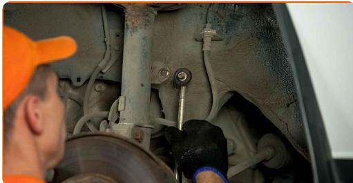
9 Koble ledningene og bremseslangen fra braketten på fjærbeinet. Bruk en pipenøkkelinnsats #12. Bruk en skrallenøkkel.
