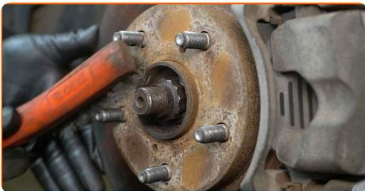
**18** Behandle overflaten hvor bremseskiven kontakter felgen. Bruk keramisk pasta.
