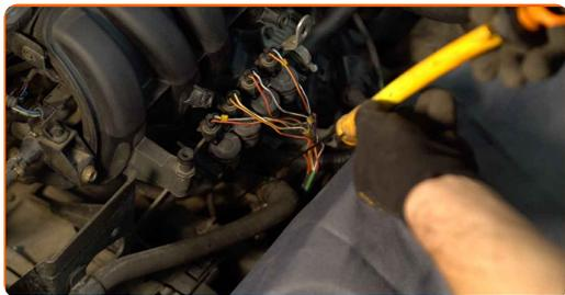
**6** Skru løs festene på innsugningsmanifolden. Bruk HEX nr. H6. Bruk en pipenøkkelinnsats #13. Bruk en skrallenøkkel.
