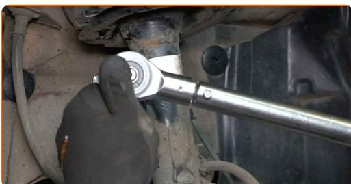
**13** Stram festene som kobler stabilisator-ledd til stabilisatorstag. Bruk en pipenøkkelinnsats #17. Bruk en momentnøkkel. Stram den til 44 Nm dreiemoment.
