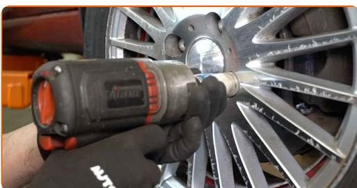
**26** Senk bilen og stram hjulboltene, arbeid på kryss. Bruk en kraftpipe for hjulmutter #17. Bruk en momentnøkkel. Stram den til 110 Nm dreiemoment.
