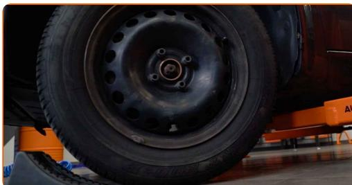
4 Løsne hjulfesteboltene. Bruk en kraftpipe for hjulmutter #19.
