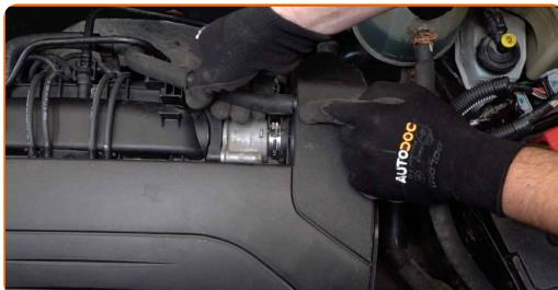
**4** Skru løs klemmen som fester luftfilter til strupeventilstuss. Bruk en flat skrutrekker.
