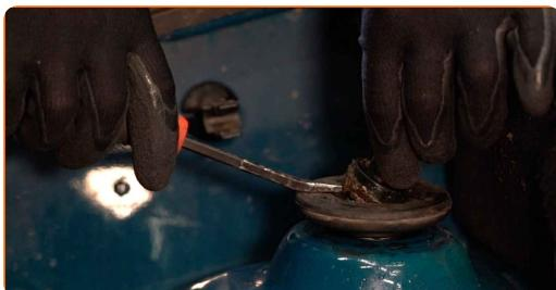
**4** Løsne det øverste festet på fjærbeinets montering. Bruk en kombinasjonsnøkkel #21. Bruk HEX nr. H6. Bruk en skrallenøkkel.
