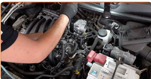
**36** Koble slangen til veivhusventilasjonen til luftkanalen. Bruk en rundtang.
