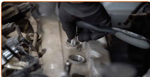
**17** Ta ut tennpluggene. Bruk en uttrekkbar magnet.
