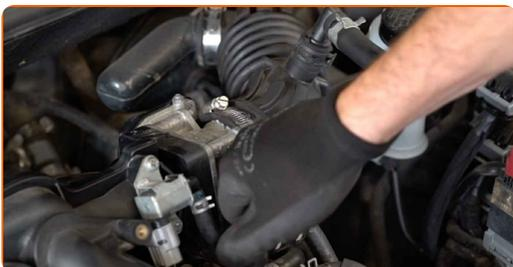
**4** Skru løs klemmene og festene på inntaksrøret til luftfilteret. Bruk en pipenøkkelinnsats #10. Bruk en skrallenøkkel.
