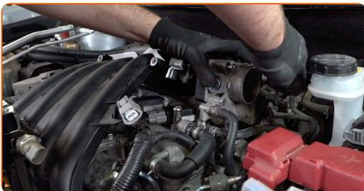
**33** Stram festene til gasspjeldet. Bruk en pipenøkkelinnsats #8. Bruk en momentnøkkel. Stram den til 10 Nm dreiemoment.
