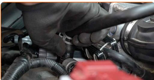
**37** Stram klemmen og festene på inntaksrøret til luftfilteret. Bruk en pipenøkkelinnsats #10. Bruk en skrallenøkkel.
