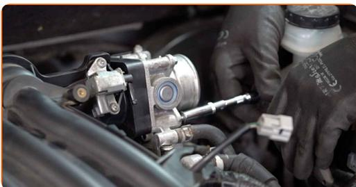
**34** Fest kontakten og vakuumslangen til innsugningsmanifolden nær gasspjeldet. Bruk en rundtang.
