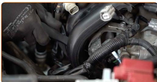
**29** Stram festene på braketten til innsugningsmanifolden. Bruk en pipenøkkelinnsats #10. Bruk en momentnøkkel. Stram den til 10 Nm dreiemoment.
