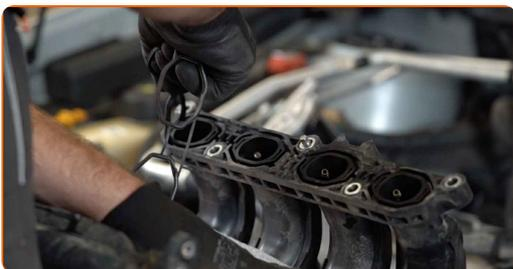
**26** Installer ny pakning på innsugningsmanifolden.
