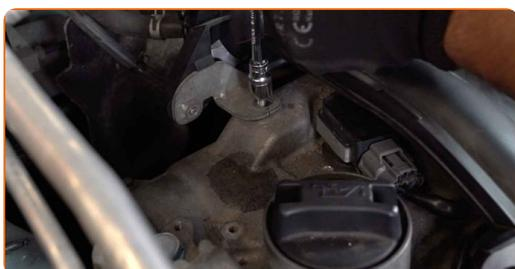
**30** Koble slangen for vakuumforsterkeren til innsugningsmanifolden.
