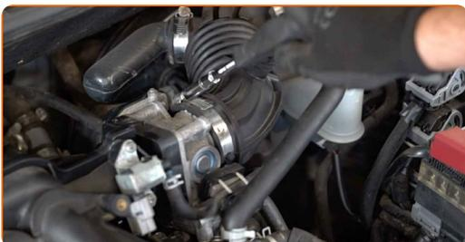
**5** Koble røret til luftinntaket fra luftfilterhuset.
