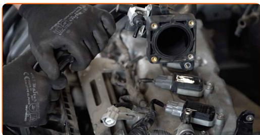
**28** Stram festene til innsugningsmanifolden. Bruk en pipenøkkelinnsats #10. Bruk en momentnøkkel. Stram den til 27 Nm dreiemoment.
