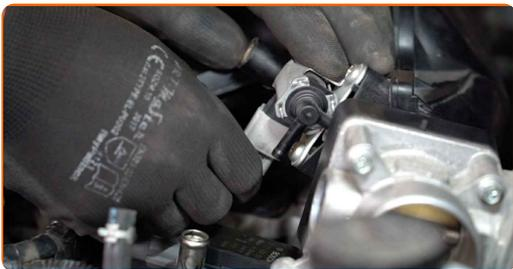
**35** Koble røret til luftinntaket til luftfilterhuset.
