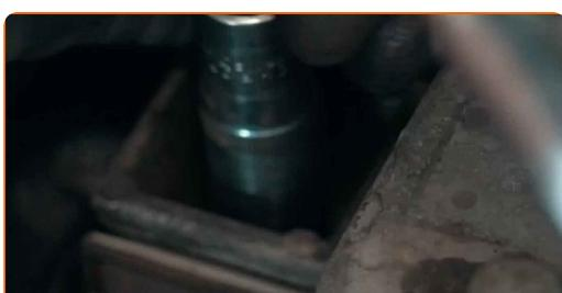
**8** Skru løs festene som holder motorfestet festet til karosseriet. Bruk en pipenøkkelinnsats #16. Bruk en skrallenøkkel.
