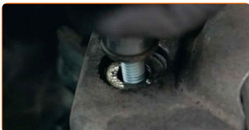
**7** Skru motorfestet løs fra braketten. Bruk en pipenøkkelinnsats #16. Bruk en skrallenøkkel.
