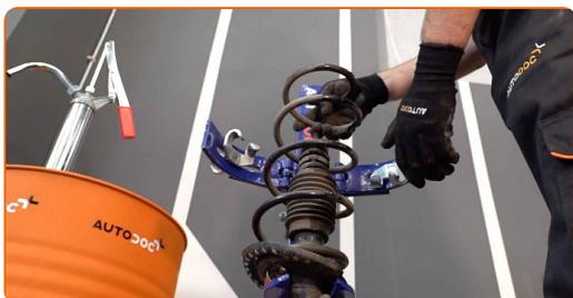
**26** Ta av støtdemper-støvhetten og støtstopperen.
