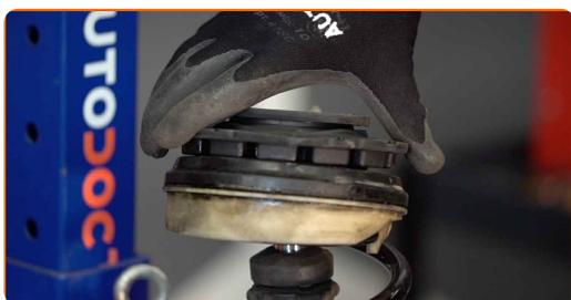
**33** Stram fjærbeinets stempelstangmutter. Bruk HEX nr. H6. Bruk en kombinasjonsnøkkel #18. Bruk en momentnøkkel. Stram den til 62 Nm dreiemoment.
