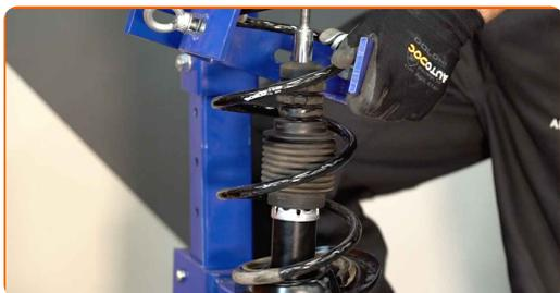
**32** Installer den øvre demperen og monteringslager.
