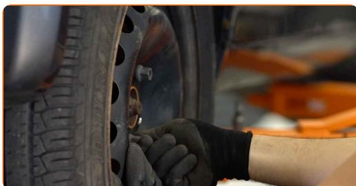
**48** Senk bilen og stram hjulboltene, arbeid på kryss. Bruk en momentnøkkel. Stram den til 110 Nm dreiemoment.
