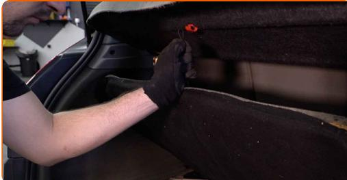
3 Skru løs støtdemperens øvre feste. Bruk en pipenøkkelinnsats #16. Bruk en skrallenøkkel.
