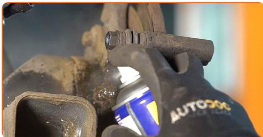
**14** Skru løs kalipperbrakettfestet. Bruk en pipenøkkelinnsats #E16. Bruk et svingjern.
