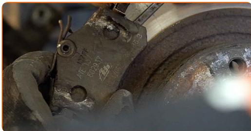
**13** Rengjør festene på braketten til bremsecaliperen. Bruk en stålbørste. Bruk WD-40 spray.
