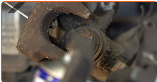
**12** Fjern bremseklossene. Bruk et brekkjern.
