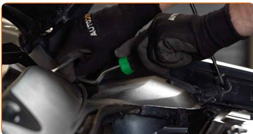
**4** Hev litt på hetten til monteringen for fjærbeinet. Behandle festene på fjærbeinets montering. Bruk WD-40 spray.
