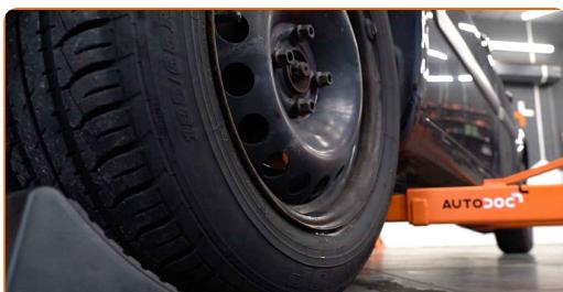
**7** Løsne hjulfesteboltene. Bruk en kraftpipe for hjulmutter #19.
