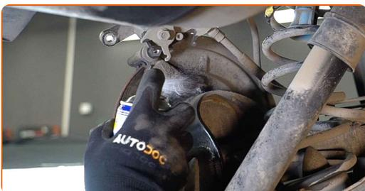
**13** Skru løs kalipperbrakettfestet. Bruk en pipenøkkelinnsats #E16. Bruk et svingjern.
