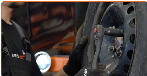
**32** Senk bilen og stram hjulboltene, arbeid på kryss. Bruk en momentnøkkel. Stram den til 110 Nm dreiemoment.
