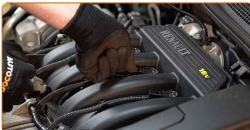
**4** Skru løs tennspolebraketten. Bruk en pipenøkkelinnsats #10. Bruk en skrallenøkkel.
