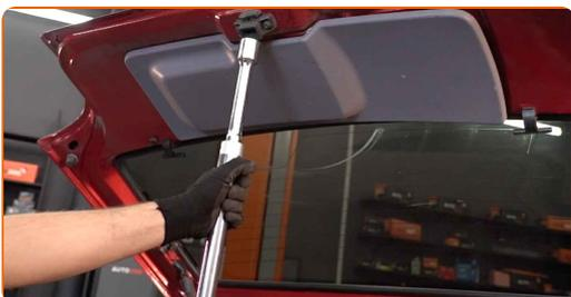
**3** Løsne på sikringsringen som kobler gassfjæren til bagasjeluken. Bruk en flat skrutrekker.
