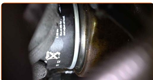
**14** Rengjør setet til oljefilteret. Bruk universal rengjøringspray.
