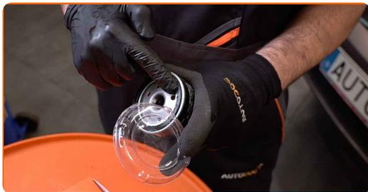
**13** Skru det nye filteret på plass. Bruk en 76/14-F-pipenøkkelinnsats. Bruk en momentnøkkel. Stram den til 21 Nm dreiemoment.
