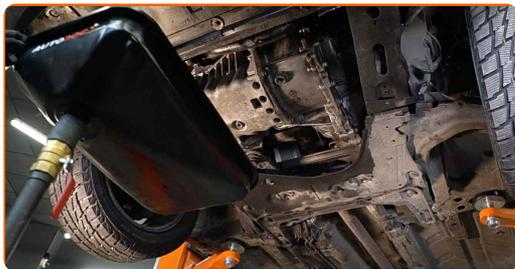
9 Skru løs oljefilteret. Bruk en 76/14-F-pipenøkkelinnsats.
