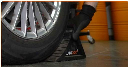
Utskifting: bremseklosser – RENAULT Zoe (BFM\_). AUTODOCs eksperter
