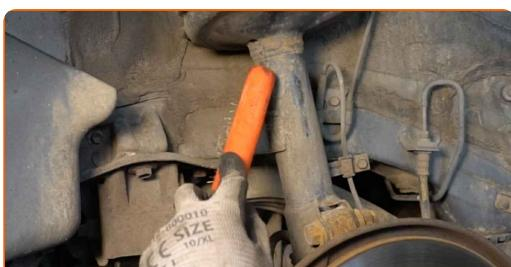
**11** Skru løs festene som kobler stabilisator-ledd til fjærbein. Bruk en pipenøkkelinnsats #17. Bruk en skrallenøkkel.
