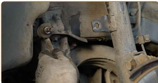
**13** Rengjør festet til ABS-sensoren. Bruk en stålbørste. Bruk WD-40 spray.
