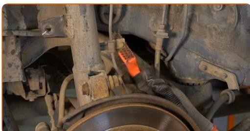
**14** Skru løs festet til ABS-sensoren. Bruk en pipenøkkelinnsats #10. Bruk en skrallenøkkel.
