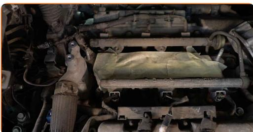
**45** Dekk over inntakskanalene til motoren med en mikrofiberklut, slik at det ikke kommer støv og smuss inn i dem.
