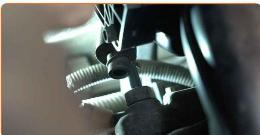
**34** Løsne slangen for veivhusventilasjonen fra motordekselet til venstre.
