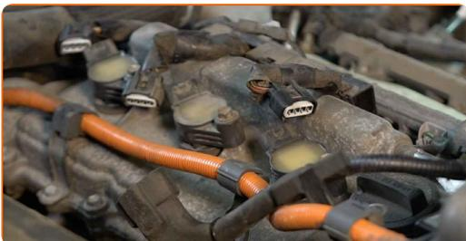
**48** Skru løs festene på tennspolene. Bruk en pipenøkkelinnsats #10. Bruk en skrallenøkkel.
