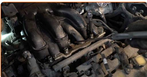
**39** Skru løs festene som kobler gasspjeldet til innsugingsmanifolden. Bruk en pipenøkkelinnsats #12. Bruk en skrallenøkkel.
