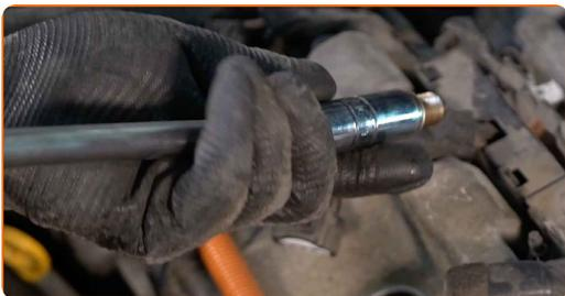
**56** Påfør et tynt lag med et spesielt høytemperaturfett på gjengene til de nye tennpluggene.
