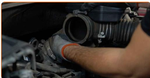
**84** Skru inn klemmen som fester luftfilterslangen til gasspjeldet. Bruk en pipenøkkelinnsats #10. Bruk en skrallenøkkel.
