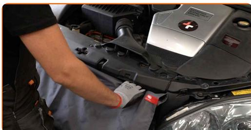
**3** Fjern radiatordekselet. Bruk et demonteringsverktøy for klemmer.
