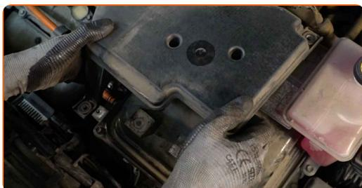
**16** Koble fra kontakten til luftmengdemåleren. Bruk en flat skrutrekker.
