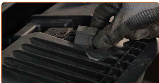
**17** Skru løs klemmen til resonatoren til luftinntaket fra luftfilterhuset. Bruk en pipenøkkelinnsats #10. Bruk en skrallenøkkel.
