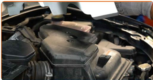
**14** Skru løs festene på luftfilterboksen. Bruk en pipenøkkelinnsats #10. Bruk en skrallenøkkel.
