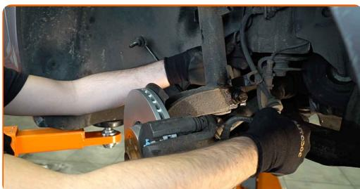
**18** Skru løs nedre feste som kobler fjærbein til styrespindel. Bruk en pipenøkkelinnsats #18. Bruk et svingjern.
