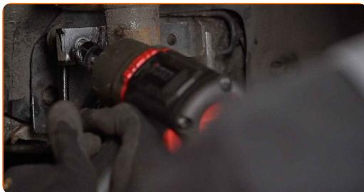
**17** Koble ledningene og bremseslangen fra braketten på fjærbeinet. Bruk et brekkjern.
