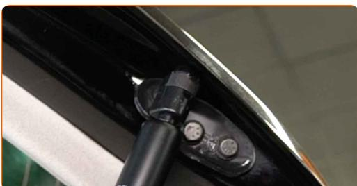
**12** Klem på sikringsringen som kobler gassfjæren til karosseriet.
