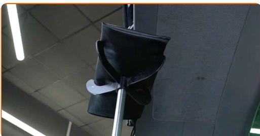
3 Erstatt sikringsringen som kobler gassfjæren til karosseriet. Bruk en flat skrutrekker.
